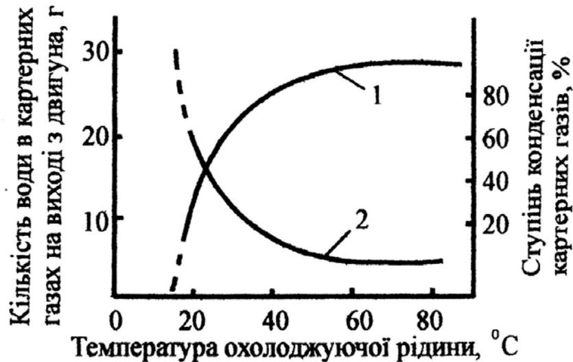
Рис. 2.6. Залежність кількості конденсату в картерних газах на виході з двигуна і ступеня їх конденсації в двигуні від його робочих температур (по воді та маслу):
