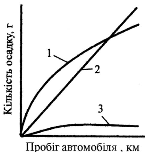
Рис. 2.7. Нагромадження осаду в маслі і на фільтрі тонкого очищення при роботі двигуна:
